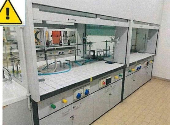
**DESCRIZIONE:** Piano di lavoro piastrellato in gres ceramico antiacido, compreso di margine antidebordante di sicurezza in PVC. Cappa con incastellatura costruita in panforte listellare ricoperta di materiale ignifugo e idrofugo classe 1 con due montanti frontali ed apertura in cristallo stratificato di sicurezza scorrevole verticalmente. Dotato di:
